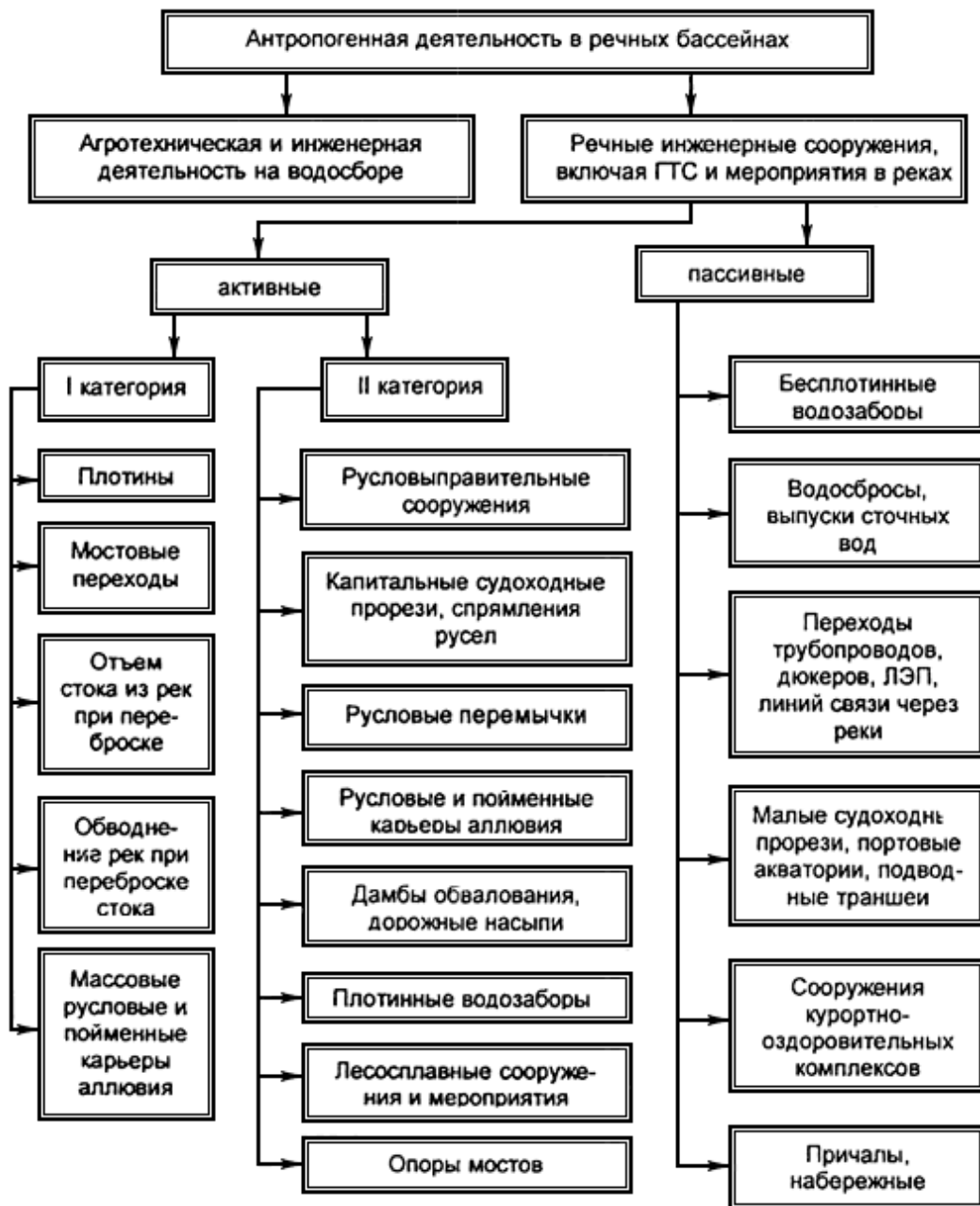
Рисунок 1 - Классификация речных инженерных сооружений, включая ГТС, и мероприятий по характеру взаимодействия с русловым процессом [4]
